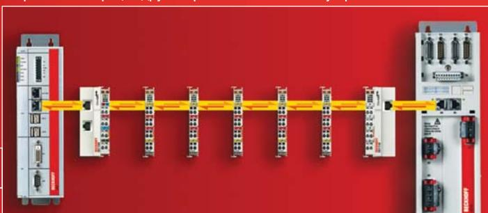
Ethernet вплоть до каждого модуля нашине с полнодуплексной топологией типа "кольцо" и передачей данных от нескольких устройств в единой телеграмме. Подключается напрямую через стандартный разъем RJ-45.
